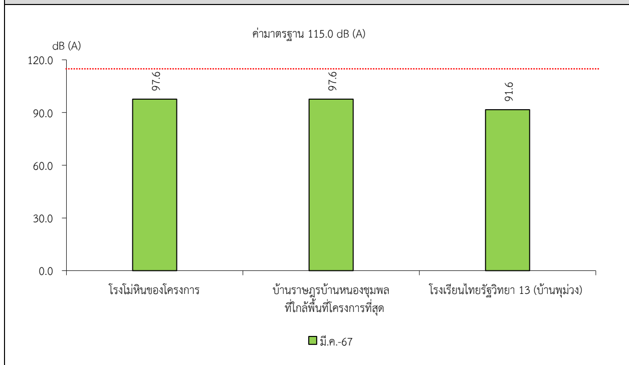
รูปที่ 3-4 กราฟสรุปผลการตรวจวัดระดับเสียงสูงสุด ( L_{max} ) เปรียบเทียบกับค่ามาตรฐาน
